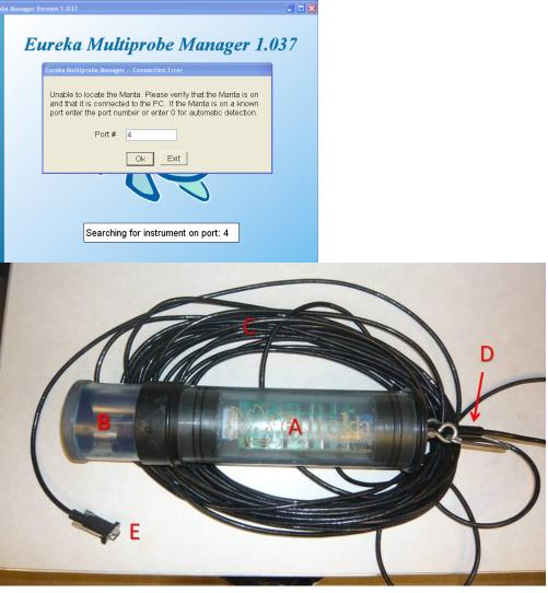
Figure 1. *Manta* overview. *Manta* parts: A) *Manta* body; B) Storage cup; C) 25 m cable; D) Waterproof, integral cable connection; E) Marine-grade serial port.
